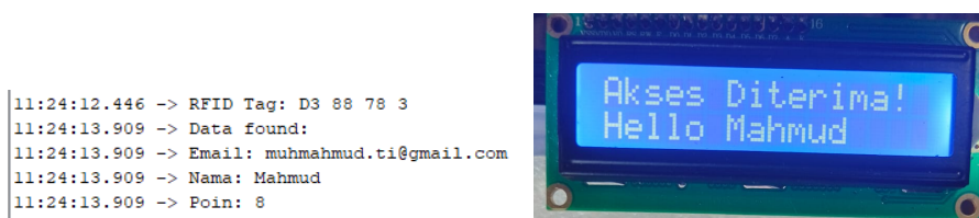
Gambar 8. Pengujian Perangkat RFID & LCD
