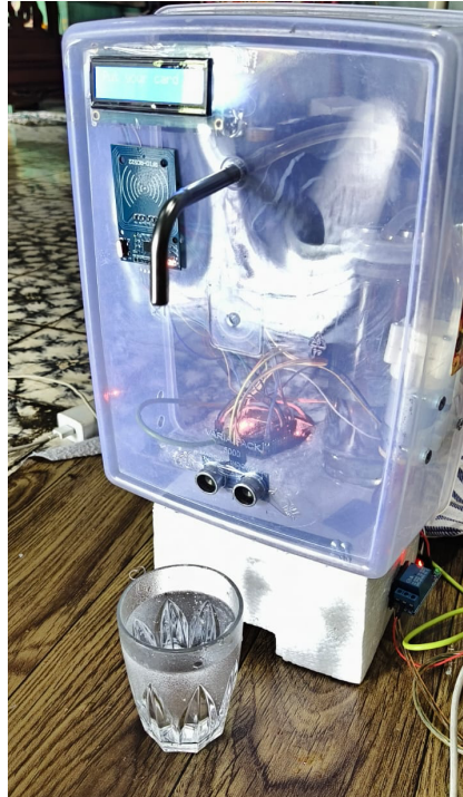
Gambar 9. Pengujian Sensor Ultrasonik & Pompa Air
